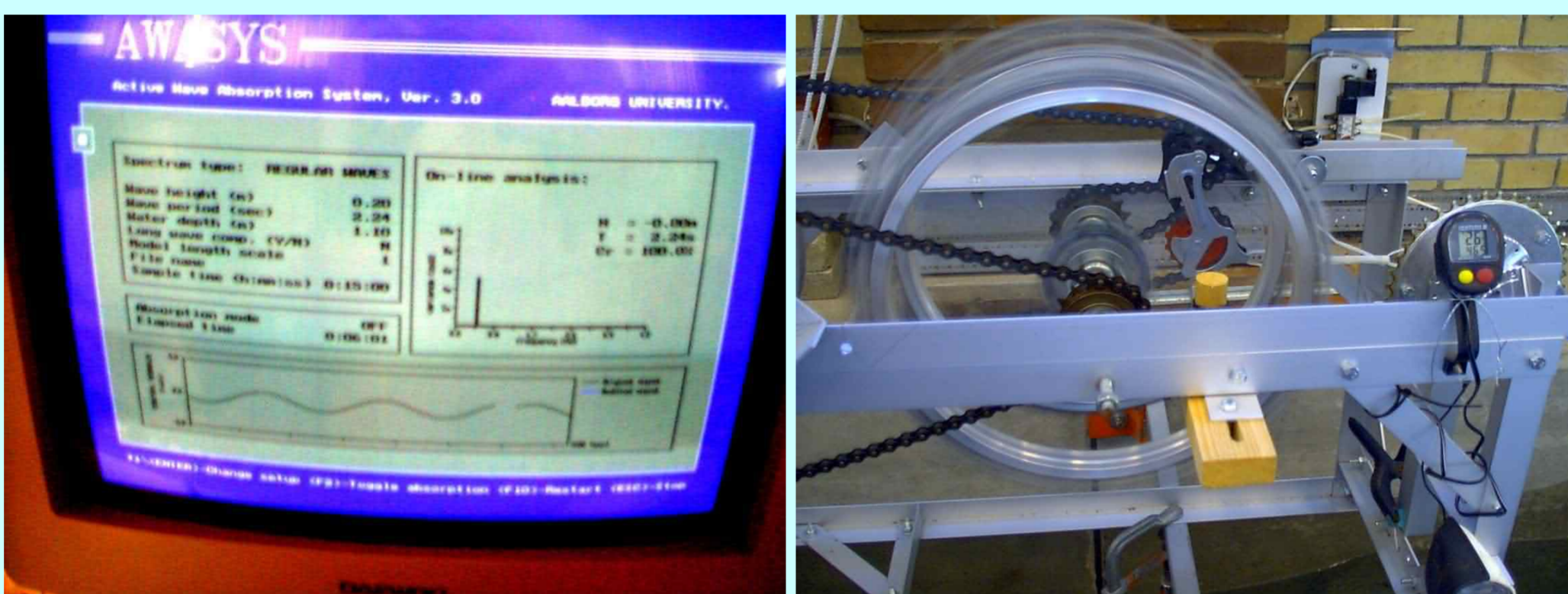
Hydraulikken styres fra en computerskærm. Energien lagres i Svinghjulene.
