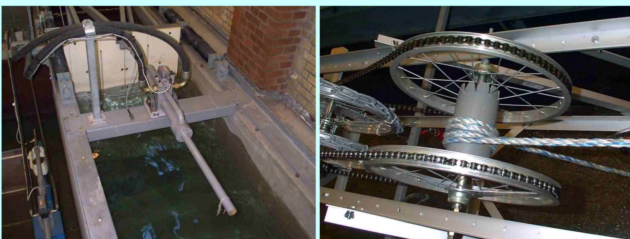
Bølgerendens hydrauliske bølge giver. Minimum trækvalseradius, r = 3,5 cm.
