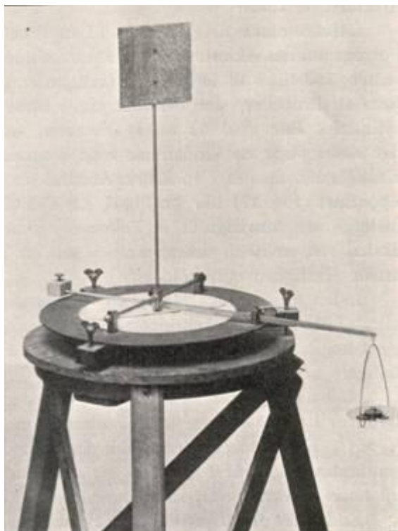
Figur 9: Billedet af vindtrykmåleren findes i bogen "Forsøgsmøllen I og II" fra år 1900.
