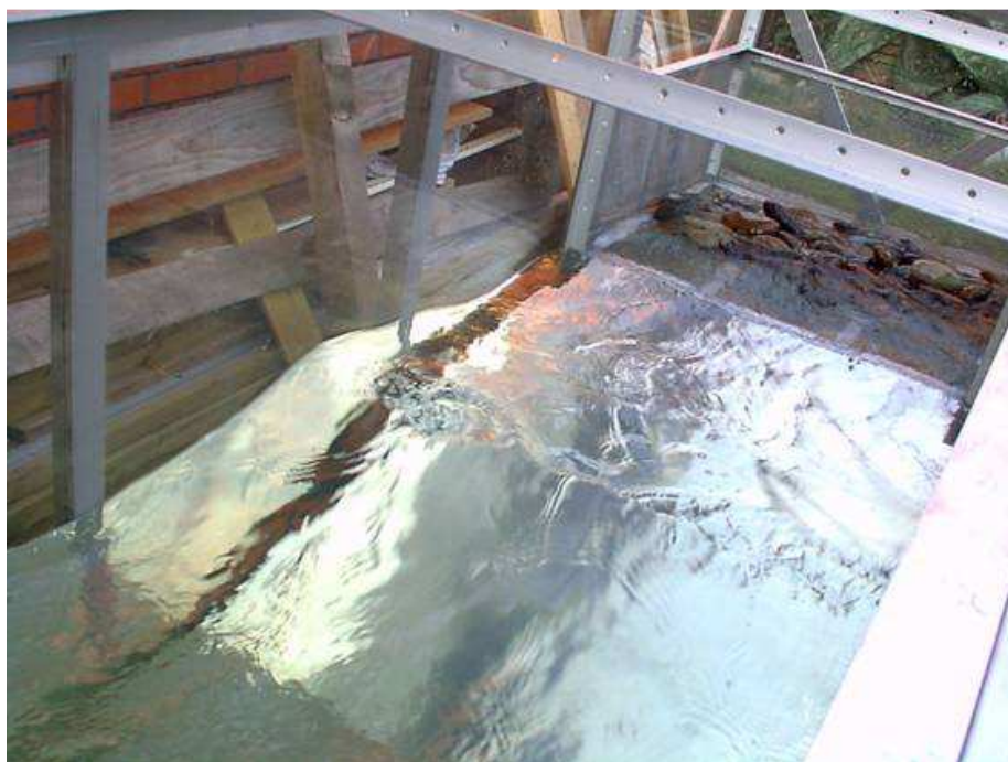
Til venstre ses bølgegeneratoren. Til højre ses den kunstige strandbred
